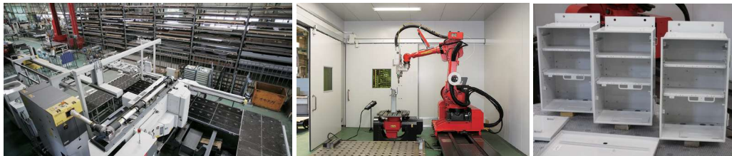
画像左:設備(板金自動加工システム)／画像中央:設備(ファイバーレーザー溶接システム)／画像右:製品(防災無線筐体)
