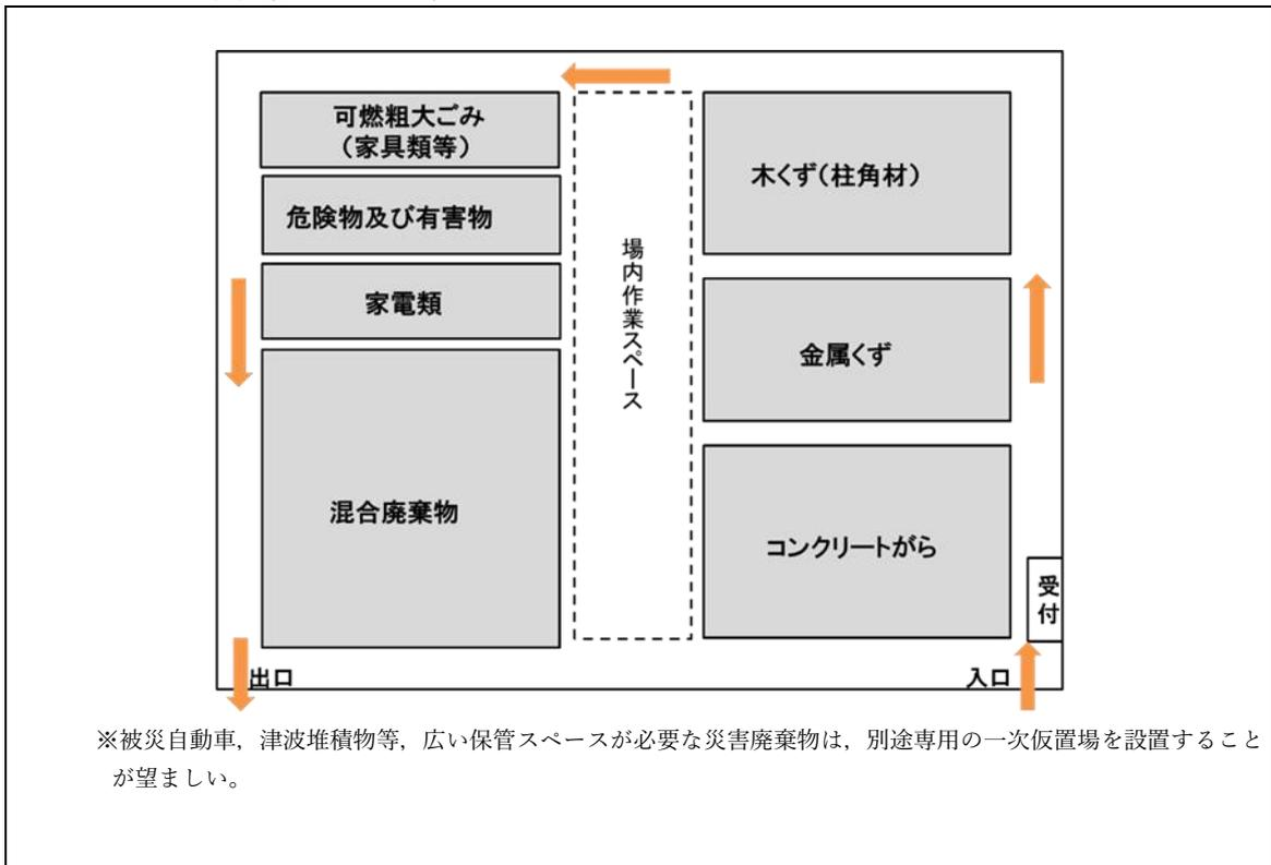
図2-3-5 一次仮置場レイアウトの例（熊本県）
