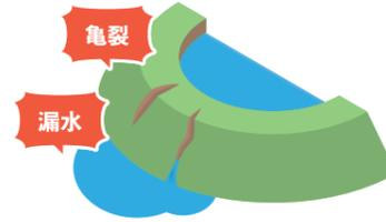
2 破損した堤体が貯水に耐え切れず決壊する。
